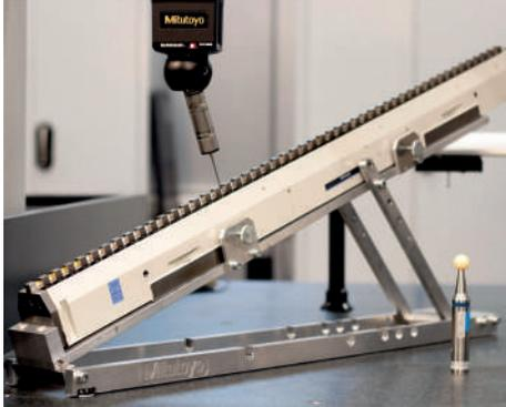
Exemple de mesure sur cale à gradin
