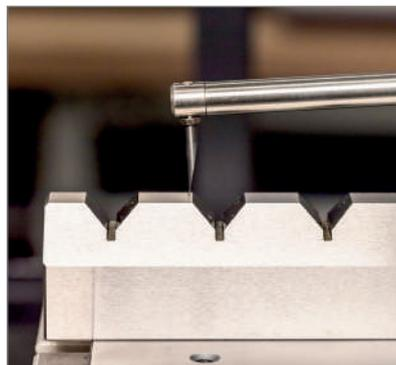
Exemple d'étalonnage de l'axe X
