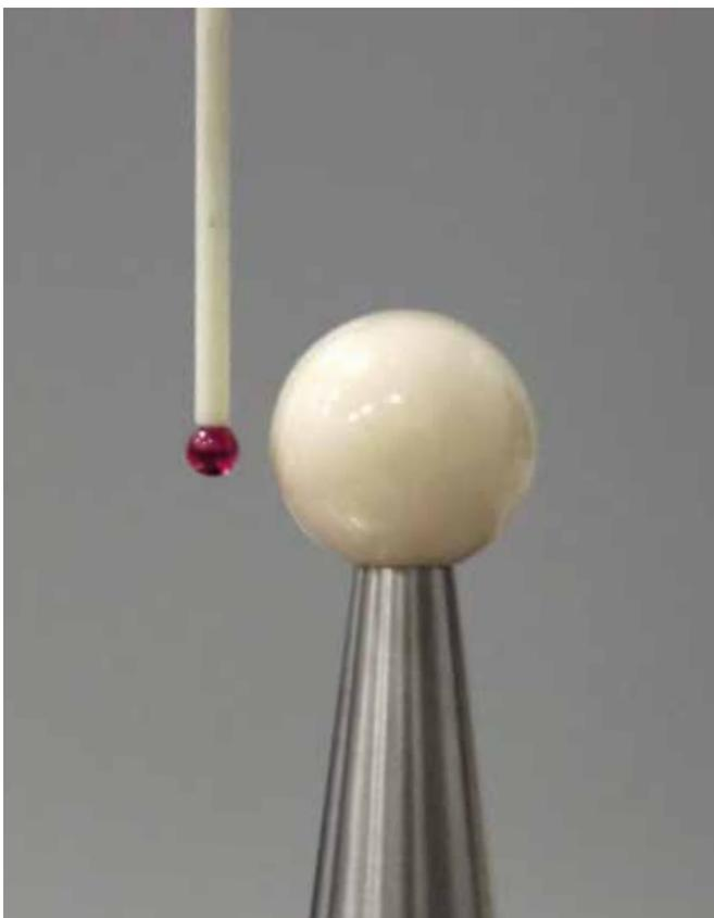
Au cours du processus de qualification, le stylet est mis en contact avec différents points préétablis de la surface de la sphère étalon.
