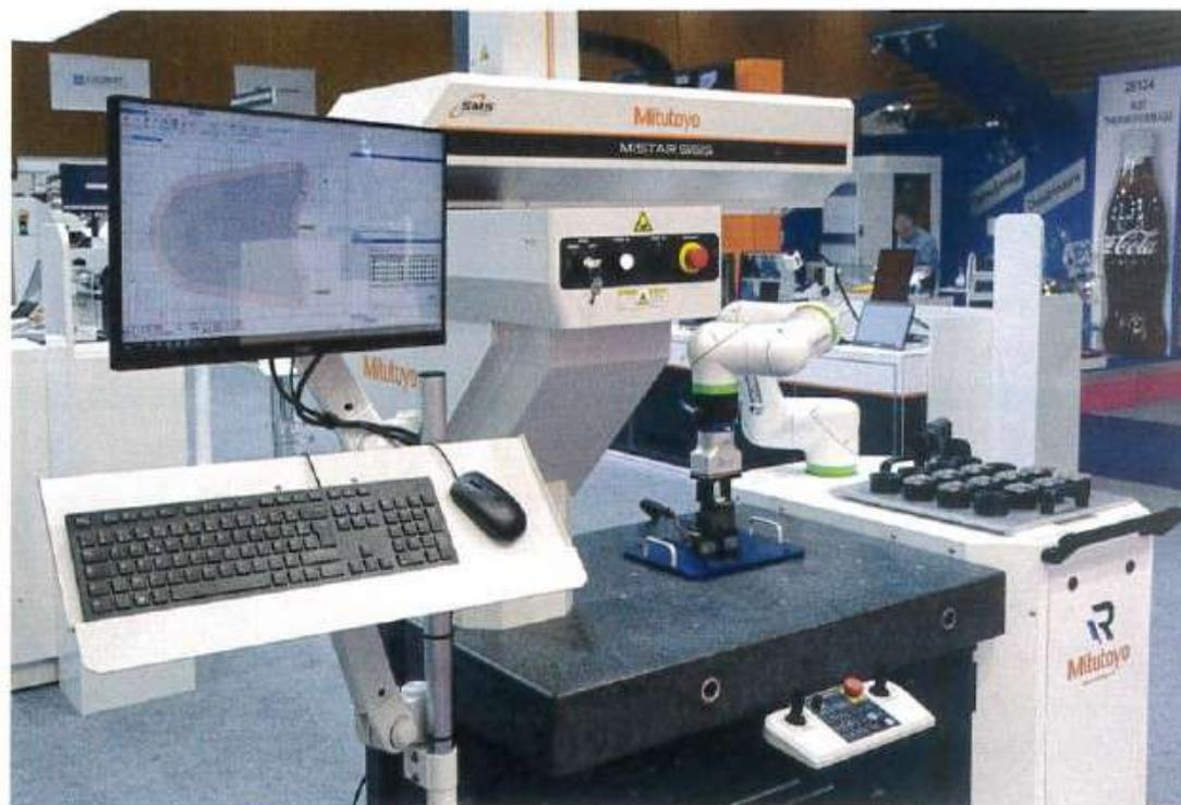
continu, et avec un changeur de stylets. M Cosmos, la suite logicielle Mitutoyo, offre des fonctionnalités de contrôle et d'inspection complètes, des géométries les plus simples aux plus complexes.
