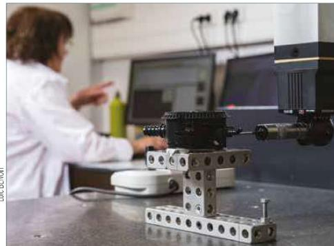
Grâce au capteur scanning, la mesure se fait en contact continu, permettant ainsi de multiplier le nombre de points.
